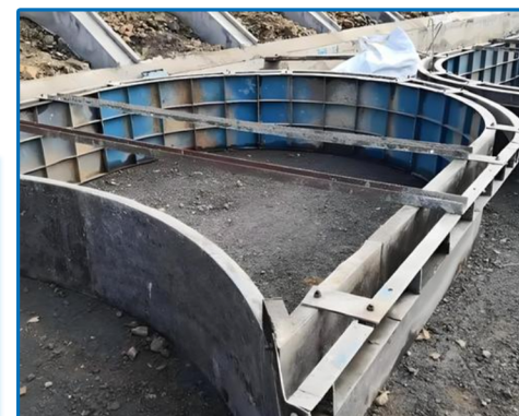
▶ 拱形护坡模板
